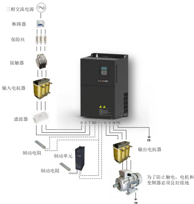
图 2-1 变频器与外围设备的连接图
